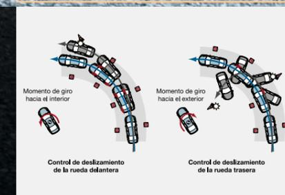
Control de deslizamiento de la rueda delantera
